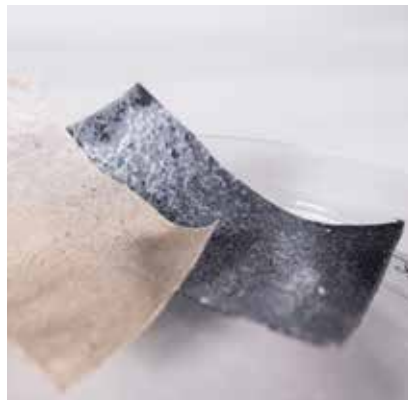
↑ Spin 10 : Restlösung auf Tüll + Seide → Fib 04.2 : Trocknung auf / zwischen Seide ↓ PEO 0.1.: Gesponnener PEO-Verlauf
